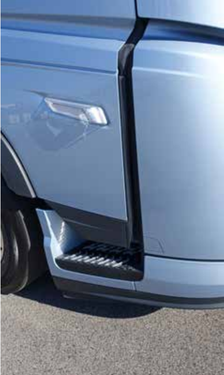
Feinschliff an allen Kurven und Rundungen: Auch kleinste Spalten sind mit Gummidichtungen verschlossen.
