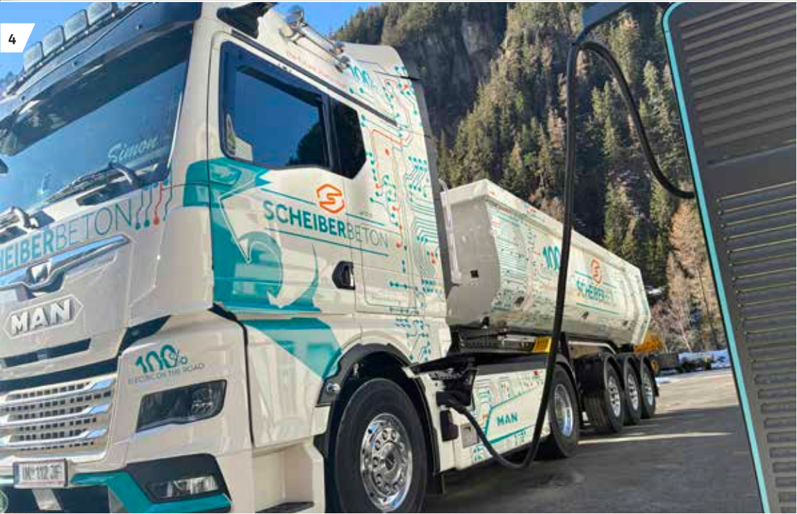
1 MAN eTGX 20.544 mit 480 kWh Batteriekapazität und 400 kW bzw. 544 PS Leistung. Es ist der erste Elektro-Kippsattel von MAN in Österreich.
