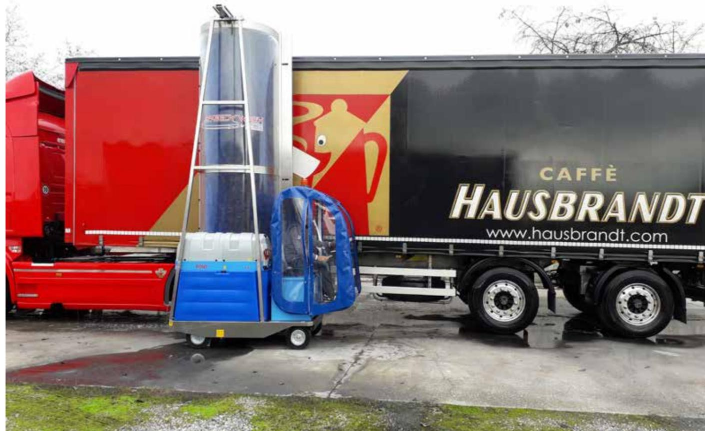
1 Der Verkaufsschlager Battery Easydrive erlaubt eine kraftsparende Nutzfahrzeugwäsche und ist einfach zu bedienen. Möglich macht es eine (optional beidseitig, standardmäßig einseitig montierte) höhenverstellbare und bewegliche Lenkdeichsel mit Bedienelementen. Durch ein einfaches Drehen des Gashebels und Einlenken der Deichsel kann die Anlage exakt am zu waschenden Nutzfahrzeug entlangefahren und dieses zuverlässig gereinigt werden.
