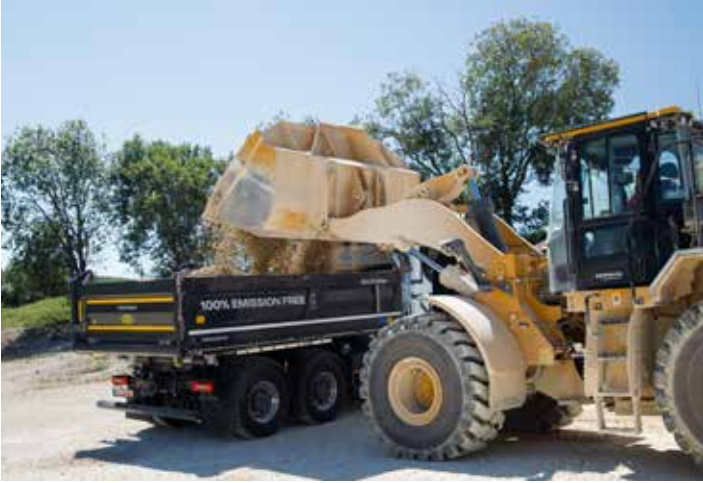
Bei der Nutzlast kann der E-Kipper 40R gegenüber dem Diesel-Pendant sogar rund eine halbe Tonne mehr bieten.
