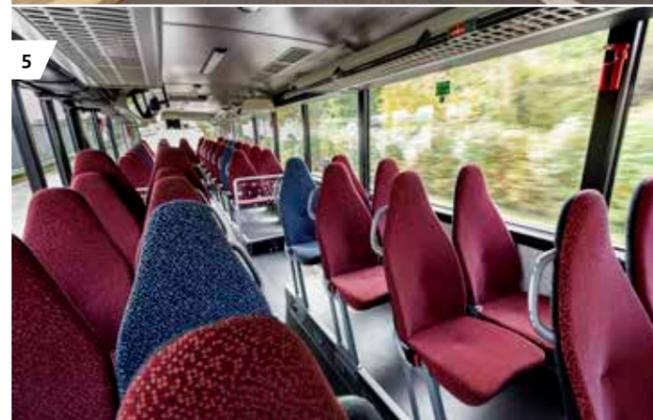
**Überlandbus Mercedes-Benz Intouro, der Alleskönner** Bei unserem in der Farbe „Aqua blau hell“ lackierten Testfahrzeug handelt es sich um einen Mercedes-Benz Intouro mit 12,18 m Länge, der ein echter Alleskönner unter den Omnibussen ist. Dieser hochmoderne Hochboden-Überlandbus mit zwei Achsen im klassischen Format bietet 51 Passagieren Platz. Nach dem Einstieg über eine 900 mm breite einflügelige Außenschwingtür empfängt uns ein freundlich gestalteter Fahrgastraum.
