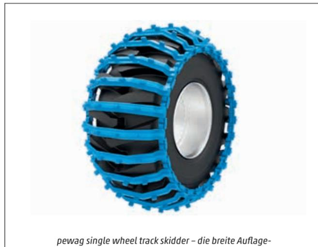
pewag single wheel track skidder – die breite Auflagefläche verhindert das Einsinken im Untergrund.
