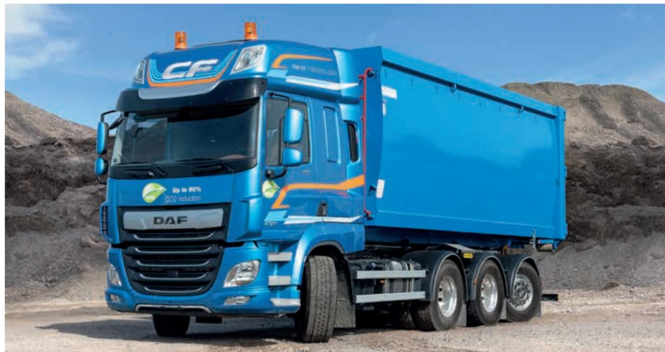
für einen Wendekreis von gerade einmal 15,6 m sowie eine unübertroffene Manövrierbarkeit. Das Fahrgestell ist perfekt für einen Kipper-, Betonmischer- oder Hakenlift-Aufbau geeignet.
