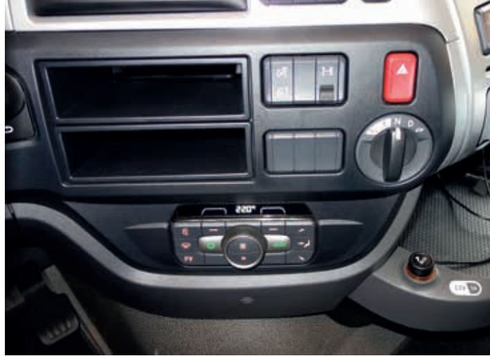
Zu tief angeordnetes Bedienpanel für Klima und Lüftung
