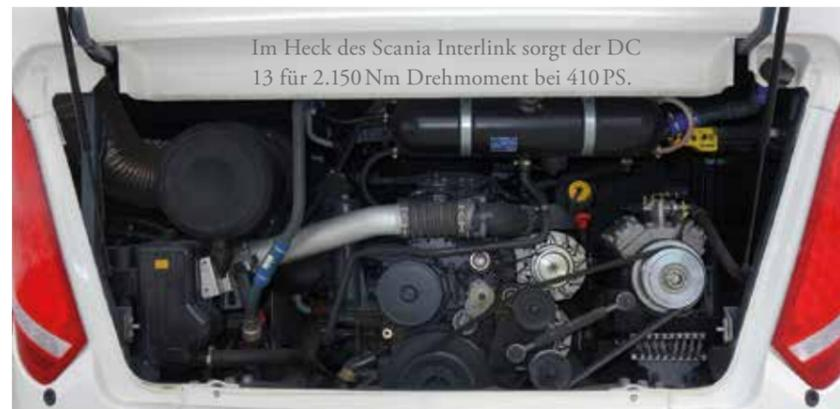
Im Heck des Scania Interlink sorgt der DC 13 für 2.150 Nm Drehmoment bei 410 PS.
